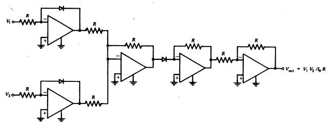
Fig. 9.12 Analog multiplier circuit.
