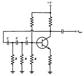
Fig. 10.3 RC phase shift oscillator
