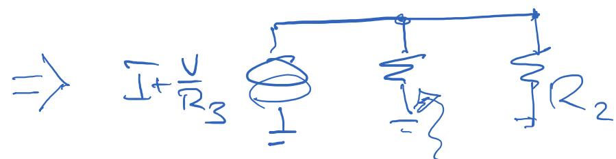
$$\Rightarrow I + \frac{V}{R_3} = \frac{R_1 || R_3}{R_1 || R_3 + R_2} \left[ I + \frac{V}{R_3} \right]$$
